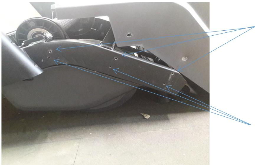
Места крепления крышки моторного отсека для эксплуатации дорожки.
